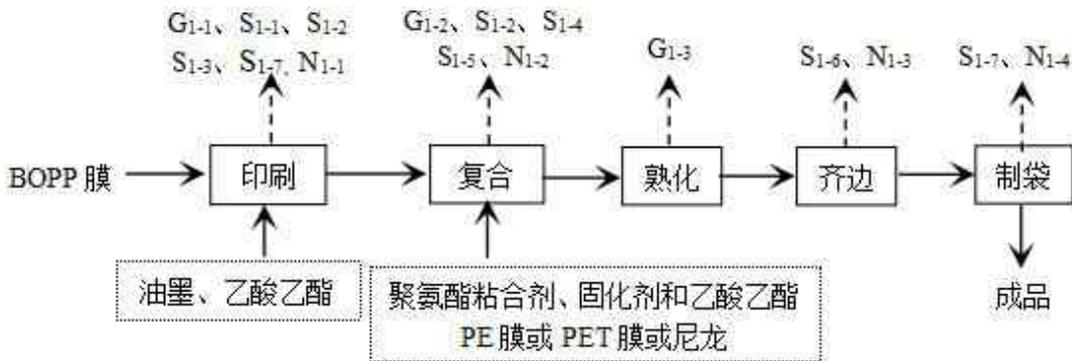
图 2-2 印刷成品袋生产工艺及产污环节图
