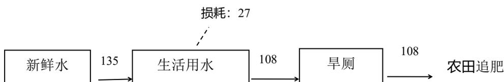
项目水平衡图 (m<sup>3</sup>/a)
