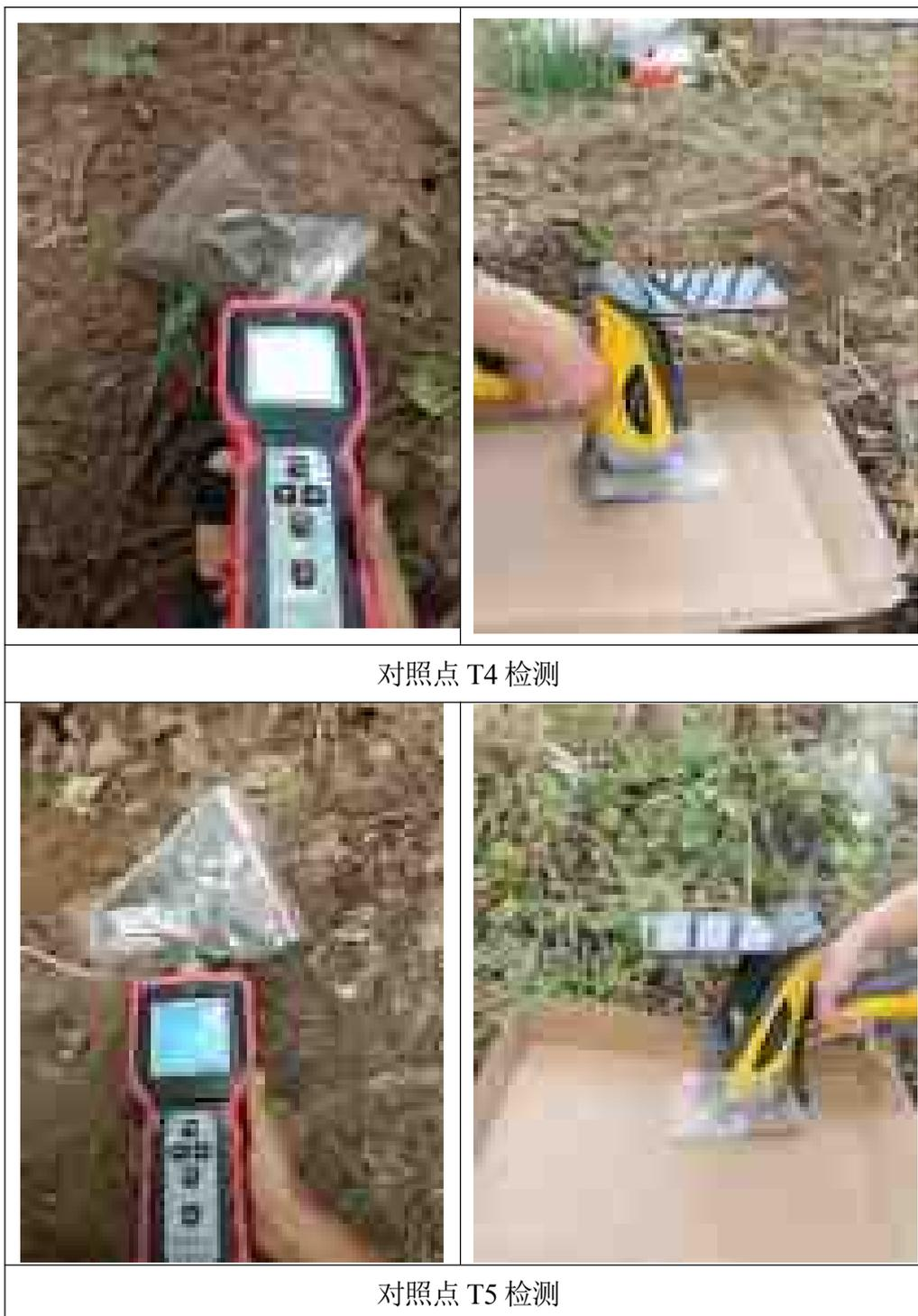
图 4.2-3 现场 PID 检测
