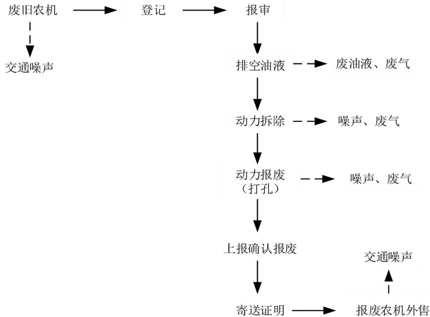
图 2-2 生产工艺流程及产污环节图
