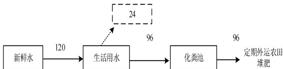
图 2-1 用水平衡图(单位：m<sup>3</sup>/a)
